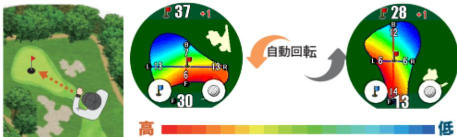
現在地から見たグリーン形状と同じになるように表示が自動回転して、幅、奥行き、フロントエッジ、センターまでの距離を表示します。
