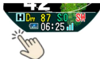
左下のH・Vをタップすることで、水平距離・目安距離の切替が可能です。
